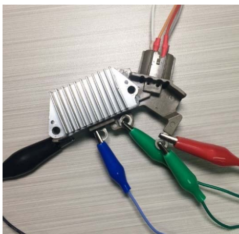
Figure 21 - 穩壓器 ARE6076 與測試儀連接圖
